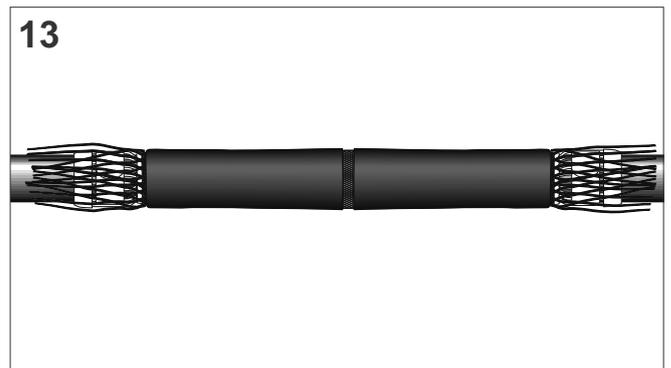
Die größere Rollfeder über das Cu-Geflecht des Muffenkörpers wickeln. Darauf achten, dass die große Rollfeder genau über die kleinere positioniert wird.
