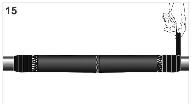
Zwei Lagen Mastikband auf jeder Seite der Muffe direkt neben dem PVC-Band auf den Kabelmantel wickeln (siehe Zeichnung).
